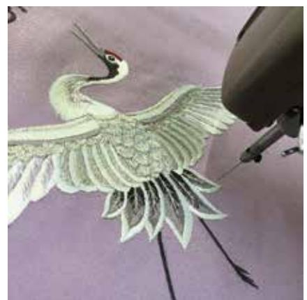
このミシンは、電子制御で誰でも使える最近のミシンとは違い、ひざで針のふり幅をコントロールし、足のペダルで針の速度をコントロールし、手で刺繡枠を動かしながら柄を作っていくので、長年の鍛錬による熟練の技が必要なのですが、写実的な表現ができ、また手刺繡に比べて、速度が速いため、生産効率もよくボリュームのある柄にも向いています。
